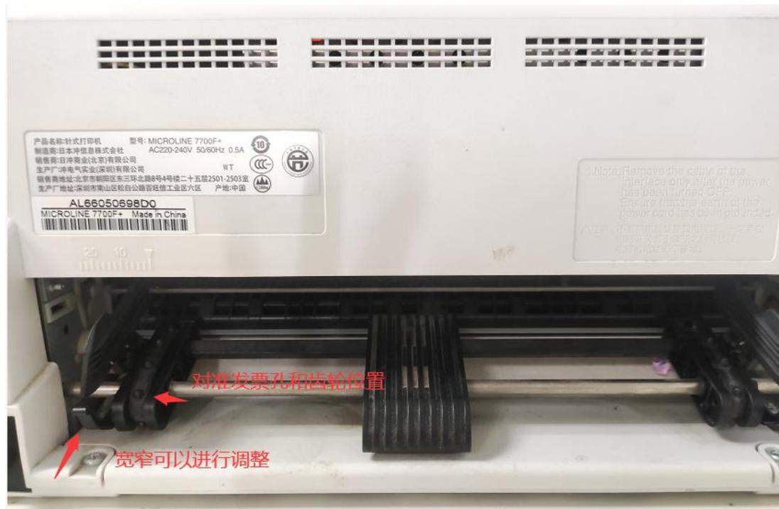
2. 在打印机后面调整宽窄，发票孔对准后边的齿轮位置，固定
