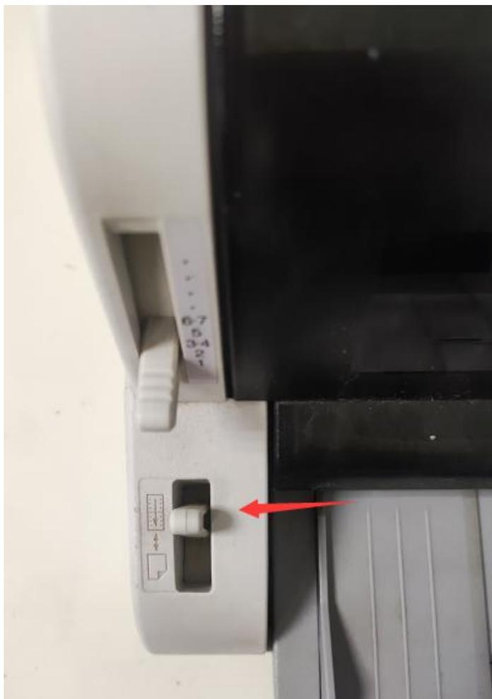
1. 设置成后进纸看打印机前面设置的这个拨动杆，往后扳，就是后进纸
