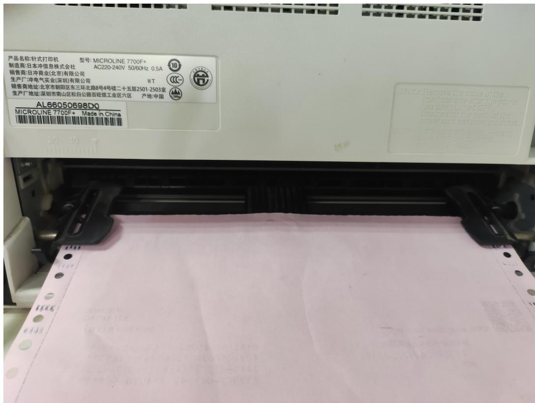
**注意：批量打印需提前测试好打印调试，确保打印完整发票孔要保持顺直，不要弯曲，褶皱，避免打印有误差**
